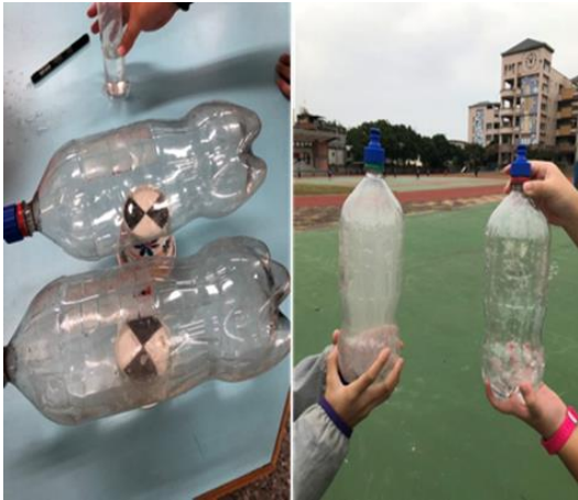
圖 35 相對減壓雲霧產生實驗利用 Secchi Disk 來量化記錄雲霧延遲時間長
