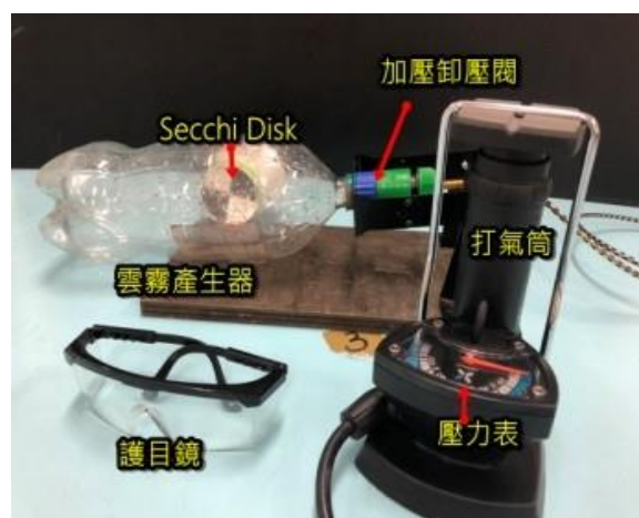
圖 34 模擬雲霧形成的設備
